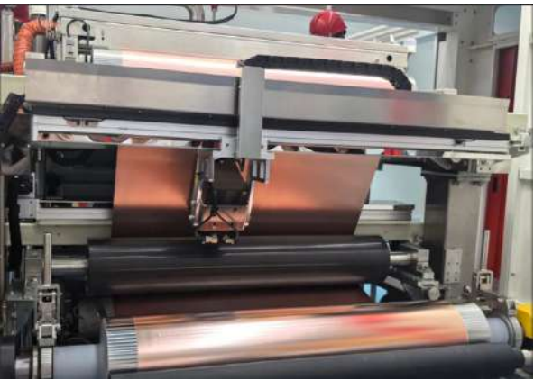
江西诺德试产 4 微米锂电铜箔
